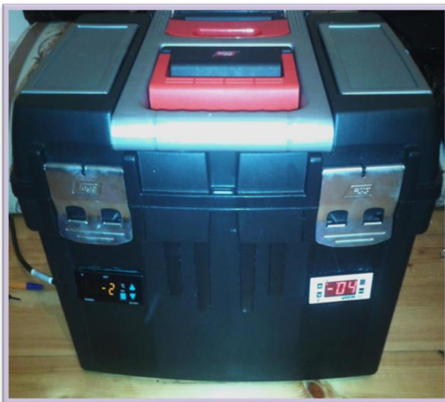
В корпус термостата вмонтирован съемный аккумуляторный источник постоянного электрического тока. Такая конструкция обеспечивает возможность хранения и транспортировки одновременно нескольких биологических субстанций с различными температурами хранения.
